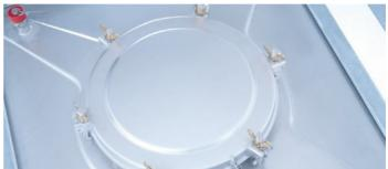
Tiefgezogener Ober-und Unterboden sorgen für hohe Formstabilität. Schraubdeckel mit Scharnierverschluss durch 6 Hammerschrauben mit Flügelmuttern Überdruckventil UH/D2 (öffnet spätestens bei 0,65 bar)
