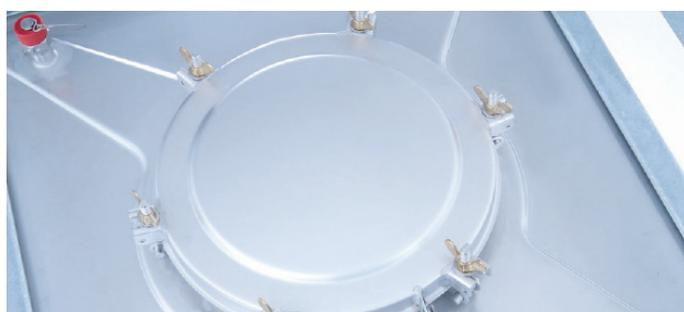
Semicuerpo superior e inferior embutido en una sola pieza asegura la estabilidad intergral del contenedor. Tapa con bisagra y 6 tuercas de mariposa. Válvula de sobre presión UH/D2 (abre a +0,65 bares).
